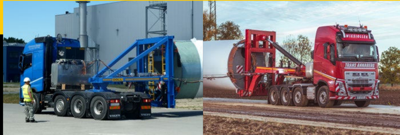
Hubadapter mit mechanischer Lifteinrichtung für 3- oder 4-Achs-Lkw (abhängig von zulässiger Achslast)
