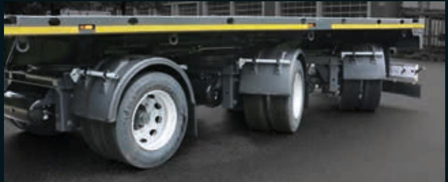
Fahrwerk doppelt bereift
