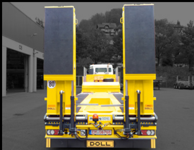
Doppelrampe hydraulisch mit Gummibelag
