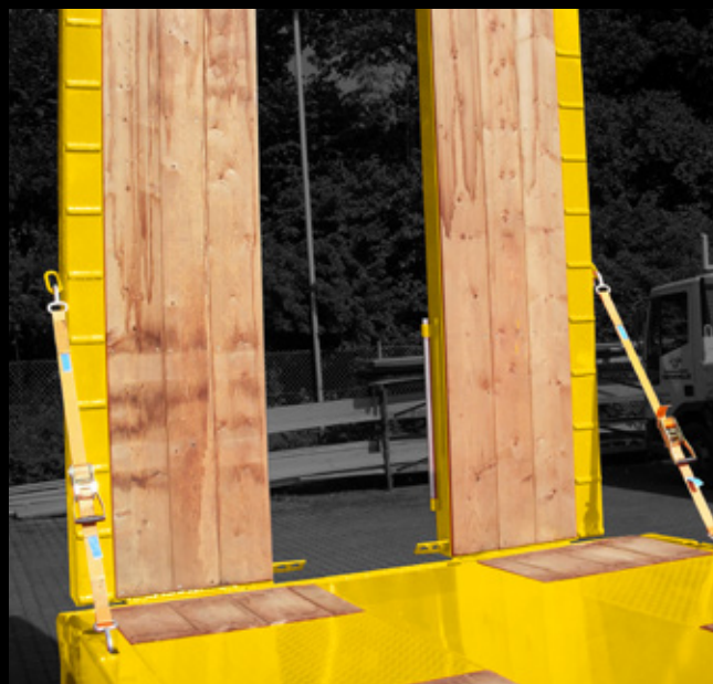
Einteilige Rampe, mechanisch verstellbar mit Holzboden
