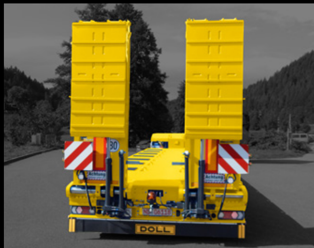
Doppelrampe mit Kletterleiste hydraulisch verbreiterbar
