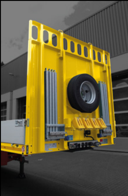
Stirnwand mit Rungendepot außen
