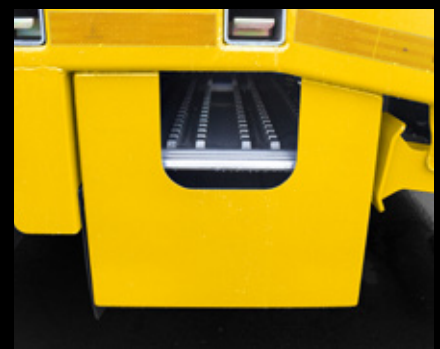
Ablage für Anlegerampen
