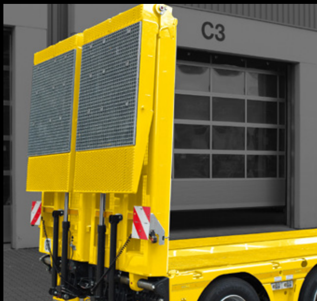
Doppelrampe hydraulisch mit Gitterrostbelag
