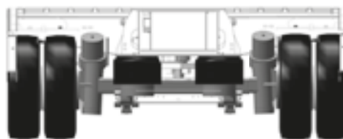
Fahrwerk Mega-Trailer, zwillingsbereift
