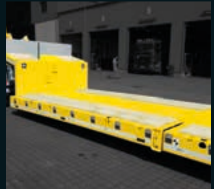
Stahlboden mit Holzfahrflächen
