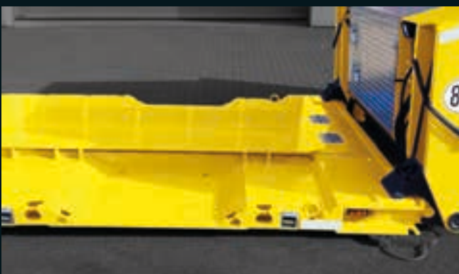
Radmulde in abgesetzter Fahrfläche
