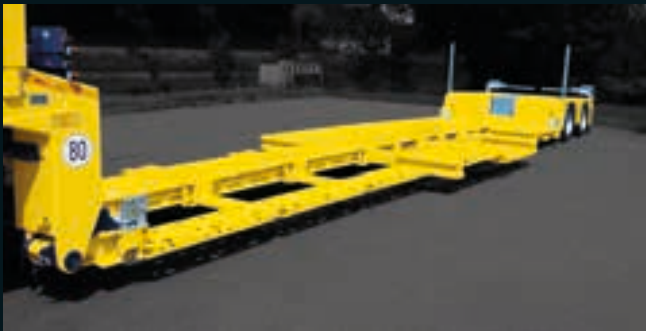
Tiefbett mit Auslegern für Mähdreschertransport
