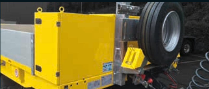
Stirnwand als Werkzeugkasten eckig
