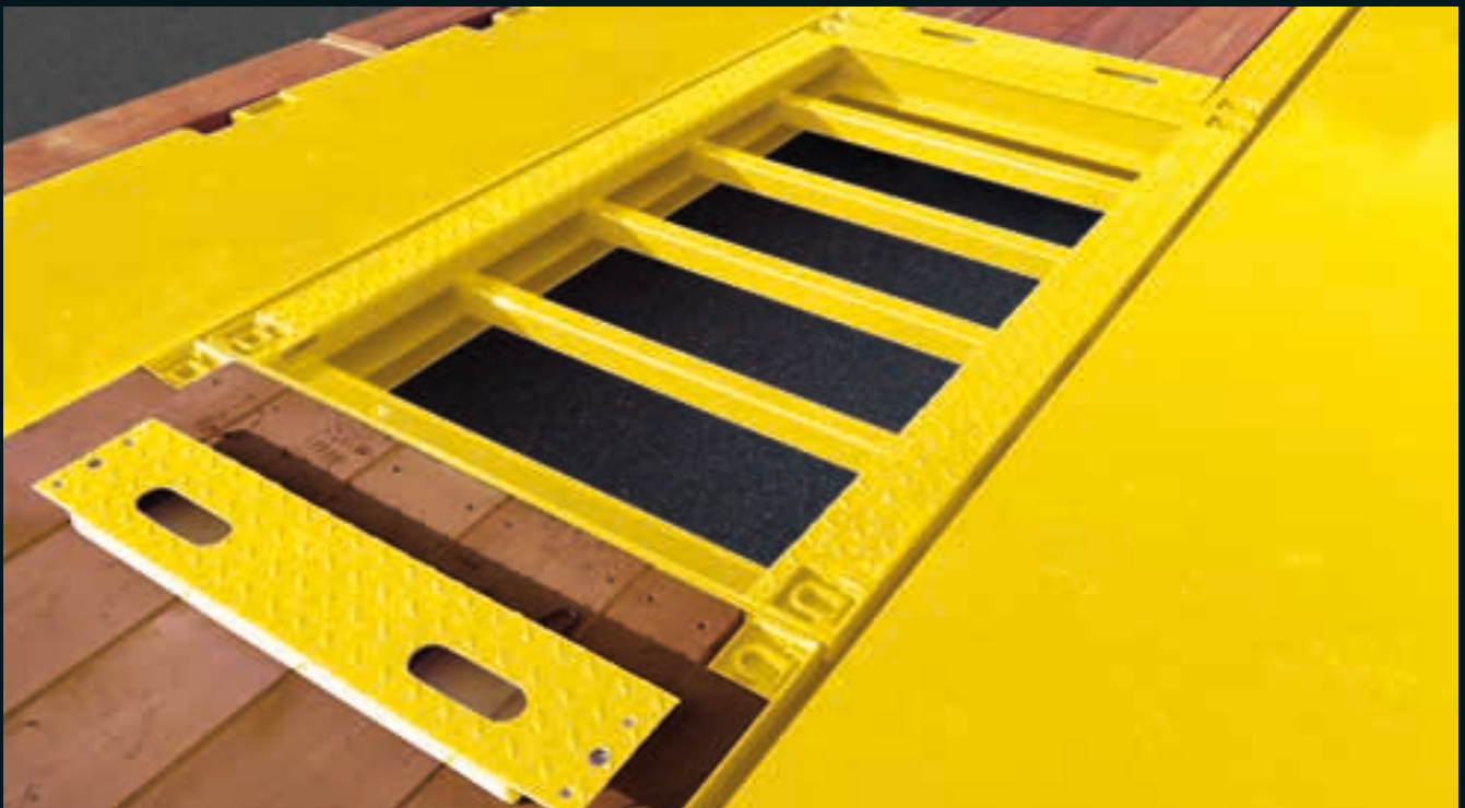
Ablage für Verbreiterungsbohlen im Tiefbett
