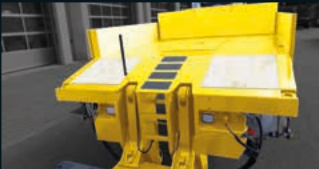
Schwanenhals mit Zentralrahmen, abfahrbar
