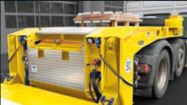
Schwanenhals mit außenliegendem Hauptrahmen, abfahrbar (Segmenti)
