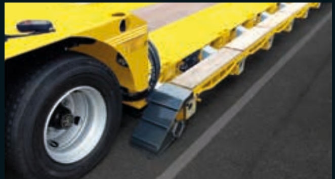
Verbreiterungen und Anlegerampe
