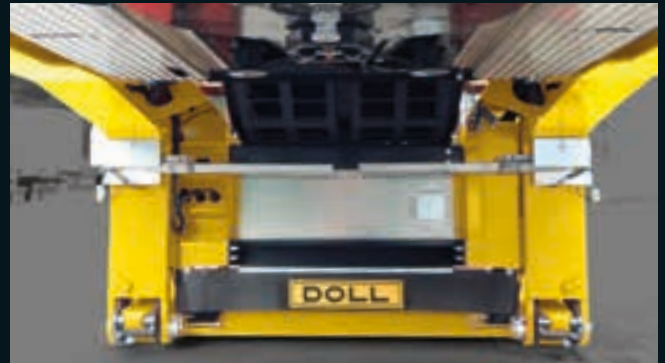
Schwanenhals mit außenliegendem Hauptrahmen, abfahrbar (Segmenti)
