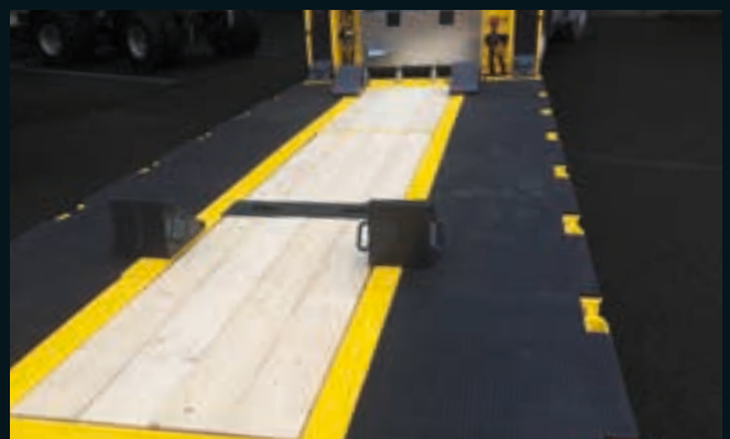
Gummibelag, Holzboden und Verbreiterung
